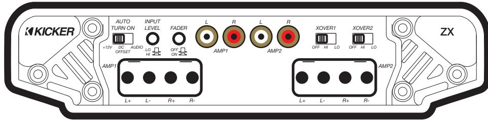
**Automatische Einschaltung:** Die ZXM-Serie bietet drei verschiedene automatische Einschaltmethoden, die an der Endplatte gewählt werden können: +12V, DC Offset und Audio. Wenn Sie „DC Offset“ oder „Audio“ verwenden, wird am REM-Terminal +12V für das Einschalten weiterer Verstärker bereit gestellt.
